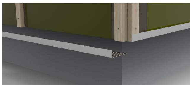
Sikring af luftspalten mod skadedyr.
