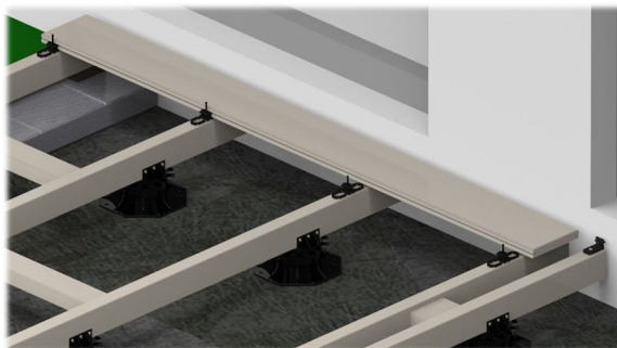
Figur 16: Første bræt. Skru ikke terrasseclipsene i, før det næste bræt er placeret korrekt.
